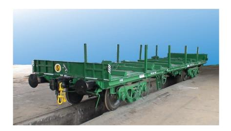
BOGIE RAILWAY SPECIAL TRANSISTIONAL COUPLING NEW WAGON BROAD GAUGE (1676 MM)
